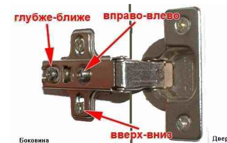
Рис.5 Крепление и регулировка петель
